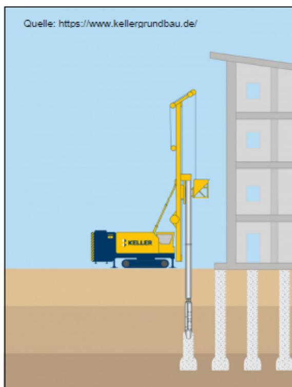
Die Rüttelstopfverdichtung erfolgt mindestens über die gesamte Auffüllungstiefe nach statischen Vorgaben, die die Anzahl und die Positionierung der Rüttelstopfsäulen miteinschließt. Die Rüttelstopfsäulen werden den Fundamentpositionen angepaßt.
